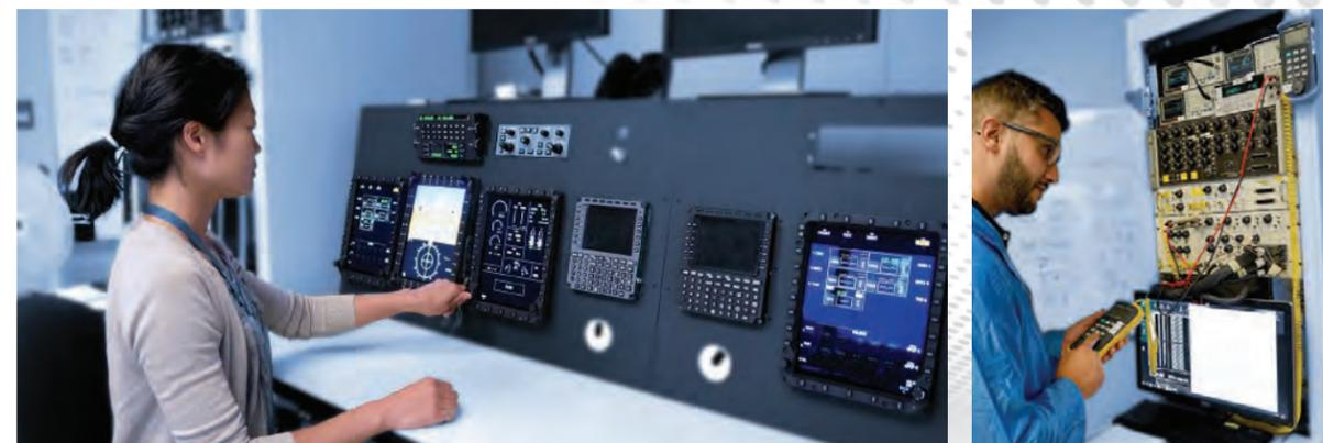
Laboratoire d'intégration : tests électriques et validation de design
