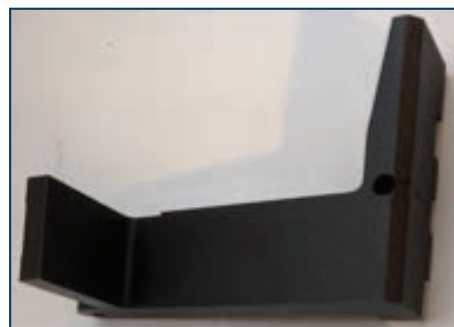
Outil en matériau composite imprimé par Siemens Énergie Canada afin d'en comprendre les paramètres d'impression et de faire les tests
